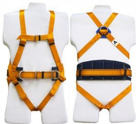
Страховочно-удерживающая привязь состоит из наплечных и набедренных лямок, заднего D-кольца, уширенного кушака и пояса для удержания и позиционирования. Привязь, укомплектованная стропом с амортизатором, образует страховочную систему.
